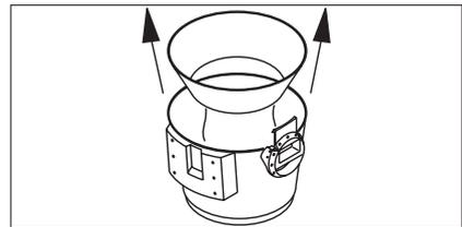
4. Setzen Sie den eventuellen Sackhalter und Trichterring wieder ein und achten Sie darauf, daß die dort und angebrachte Dichtung nicht verschmutzt oder defekt ist.
