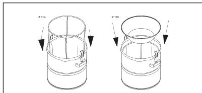
5. raccrocher le bac à poussière en faisant attention au positionnement de celui-ci (étanchéité entre le bac et le corps de la centrale) afin d'éviter toute perte d'aspiration. Refermer les deux crochets en même temps.
