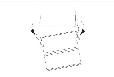
2. Ruotare la manopola in senso antiorario fino a quando il filtro non si allenta.
