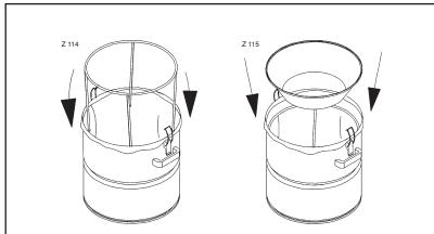
5. Schließen Sie die Befestigungs-klammern am Chassis des Gerätes und achten Sie auf die perfekte Überlappung zwischen Chassis-Rille und Staubbehälterrund, um Lufteintritt und Saugkraftverluste zu vermeiden. Schließen Sie beide Befestigungs-klammern gleichzeitig.
