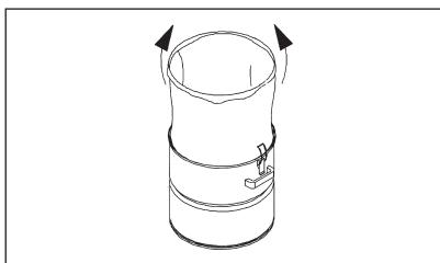
4. Riposizionare il separatore ciclonico con l'eventuale tendisacchetto, controllando che la guarnizione di battuta non sia sporca o guasta.
