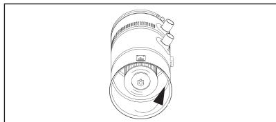
3. extraire le filtre (pour les modèles 45/2-3 avec la grille de protection) et procéder à son nettoyage soit en le secouant, soit avec de l'air comprimé par l'intérieur, soit par aspiration classique, tout en faisant attention de ne pas l'endommager. Éviter le nettoyage avec des liquides ou des détergents. Si possible effectuer ces opérations à l'extérieur. Éviter le nettoyage avec des liquides ou avec des détersifs. Si possible effectuer ces opérations à l'extérieur.
