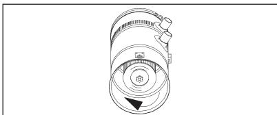
6. raccrocher le bac à poussière en faisant attention au positionnement de celui-ci (étanchéité entre le bac et le corps de la centrale) afin d'éviter toute perte d'aspiration. Refermer les deux crochets en même temps.
