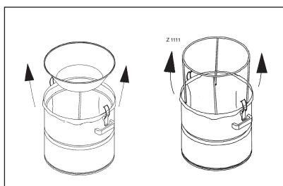
3. Entleeren sie den Staubbehälter oder Tauschen sie den Plastiksack aus.
