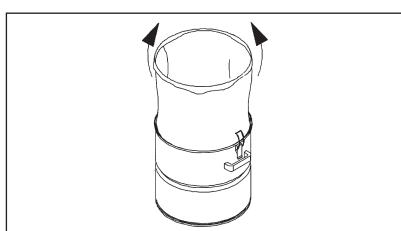
4. Setzen Sie den eventuellen Sackhalter und Trichterring wieder ein und achten Sie darauf, dass die dort angebrachte Dichtung nicht verschmutzt oder defekt ist.
