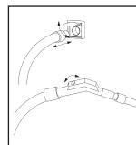
3a) Bei Saugdosen mit Mikroschaltern schaltet sich die Anlage bei Öffnung der Saugdose ein.
