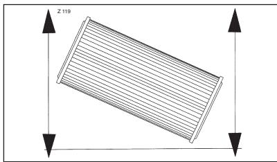
4. Assicurarsi che la griglia di protezione motore (vedi freccia sul disegno) non sia intasata, sporca o in cattivo stato.
