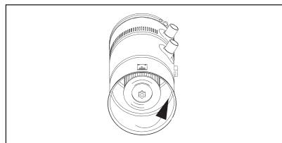
3. Reinigen Sie den Filter durch Schütteln, bzw. leichtes Ausklopfen, Drucklufteinwirkung oder Absaugung mittels eines konventionellen Staubsaugers. Achten Sie dabei darauf, das Filtermaterial nicht zu beschädigen.
