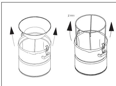
3. Svuotare il contenitore polvere o sostituire il sacchetto in plastica
