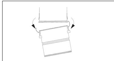
2. Drehen Sie den Drehknopf gegen den Uhrzeigersinn, bis sich der Filter lockert.
