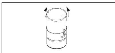
4. repositionner le bac, éventuellement aussi le porte sac et le cyclone, et contrôler que le joint n'est pas sale ou défectueux.
