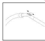
4) Sollte im Verhältnis zur durchzuführenden Reinigungsaufgabe zu viel Saugkraft anliegen, kann diese durch Öffnung des Falschlufreglers am Handgriff verringert werden.
