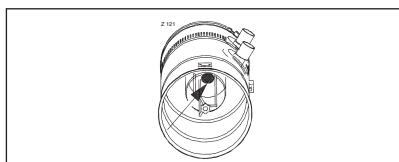
5. remonter le filtre et éventuellement la grille de protection en revisant la vis de serrage. Replacer éventuellement le sac de protection du filtre.
