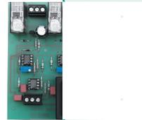
Steuermodul für Kaskadenschaltung von 2 Motoren
